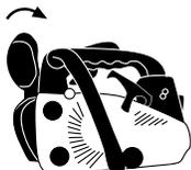
2. Desenroscar tuerca (1), tornillo (3) y retirar la tapa de la cadena (2). Una vez que quite la tapa, retire el protector de ajuste (7) si existiera.
