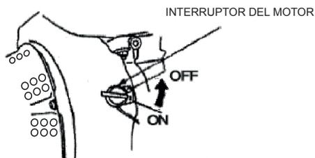
3. Desplazar la palanca de la válvula del ahogador en posición OFF.
