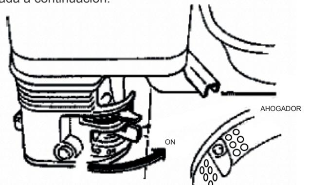
2. Desplazar el interruptor del motor en posición OFF..
