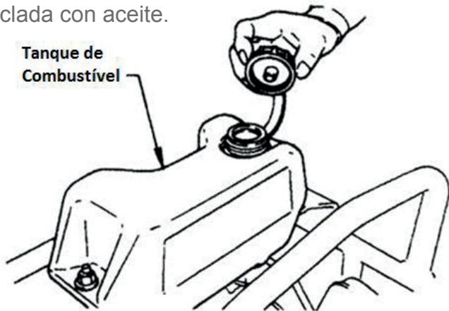
Figura 3 – Tanque de combustible
